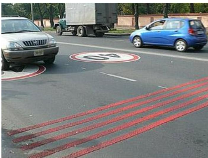
Рисунок 1.5 – Пример использования шумовых полос
