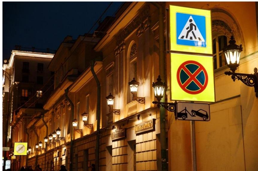
Рисунок 1.10 – Пример исполнения знаков дорожных с внутренним освещением
